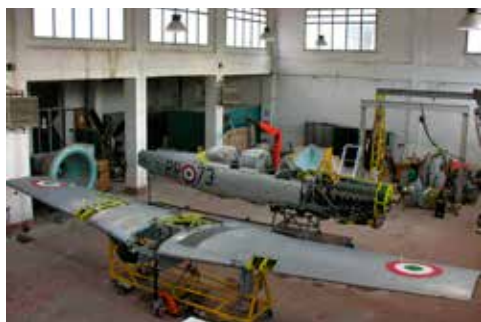
Nelle fasi iniziali del ripristino del velivolo, le ali sono state separate dalla carlinga. Nell'ala destra erano mancanti alcuni pannelli.
