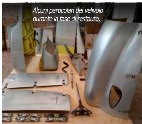
Nelle fasi iniziali del ripristino del velivolo, le ali sono state separate dalla carlinga. Nell'ala destra erano mancanti alcuni pannelli.
