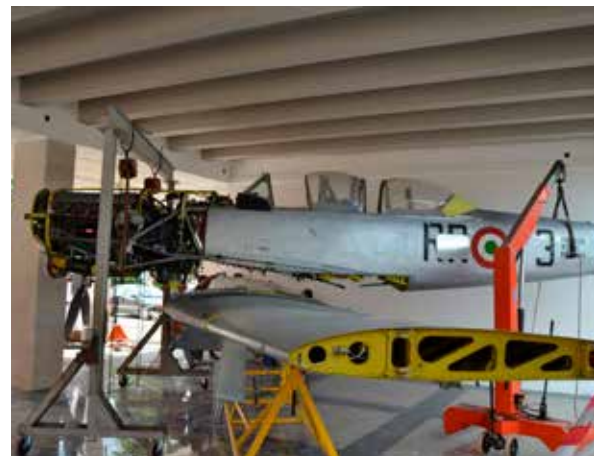
Alcune delle complesse attività durante il restauro. Dopo aver smontato le parti principali, si è provveduto al loro ricondizionamento e all'accurato rimontaggio del velivolo all'interno della teca espositiva.
