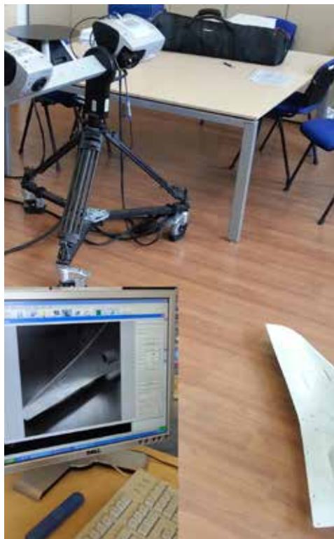
Per il restauro del velivolo sono state utilizzate tutte le più moderne tecniche. Per realizzare da zero le parti mancanti ci si è avvalsi del metodo del “reverse engineering” (impiegando anche uno scanner ottico tridimensionale) e dei sistemi CAD/CAM.
