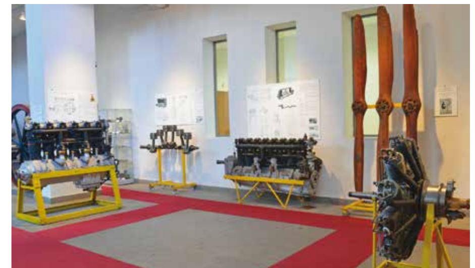
Alcuni dei motori aeronautici storici del Museo, al centro il Daimler Mercedes D IV otto cilindri in linea da 220 hp (1915)
