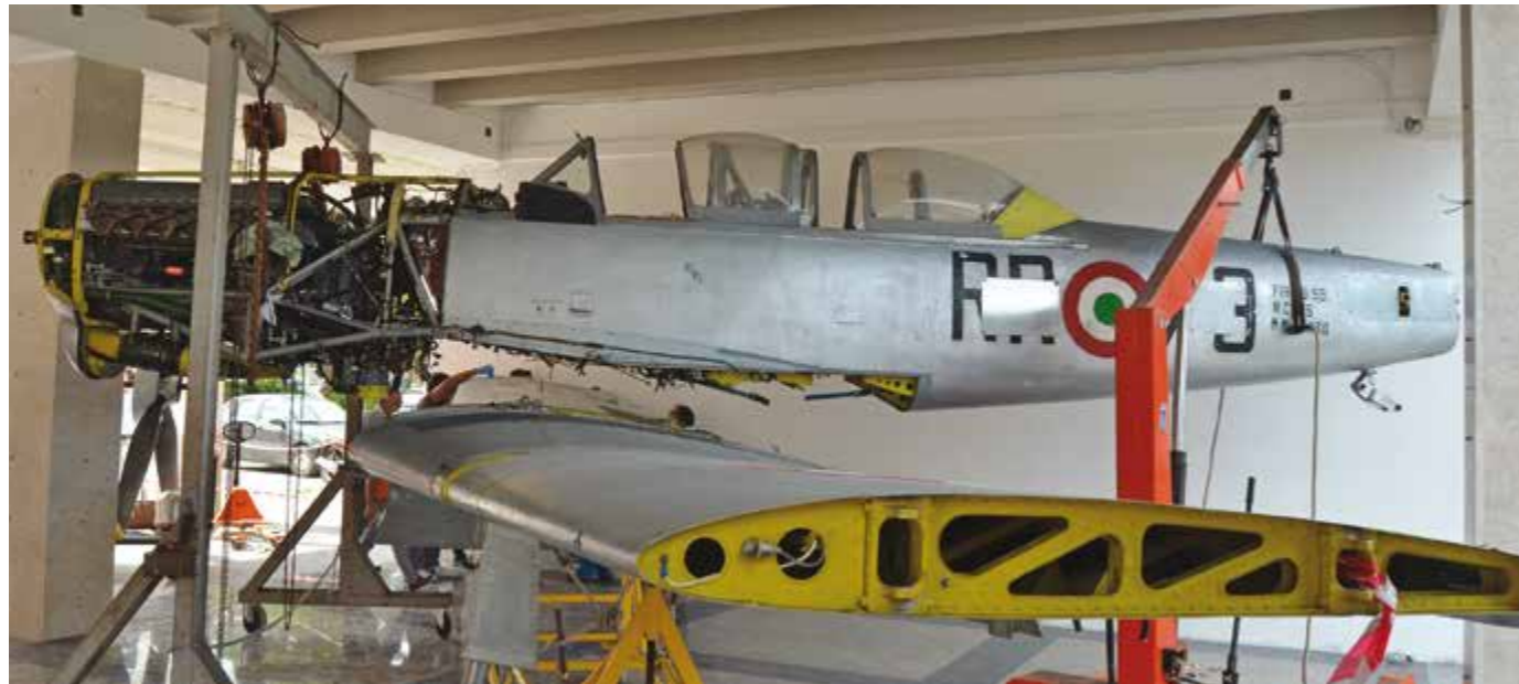
Settembre 2013, la fase di montaggio del G.59 al termine della prima fase di restauro
