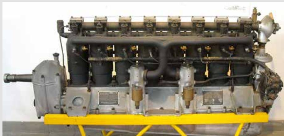
Questo poderoso 8 cilindri aeronautico della Prima guerra mondiale è il Mercedes D.IV. Molto potente tendeva alla rottura per via del lunghissimo albero motore.
