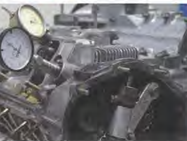
Posizionamento relativo di un asse a camme e dell'albero a gomiti con l'aiuto di comparatori.
