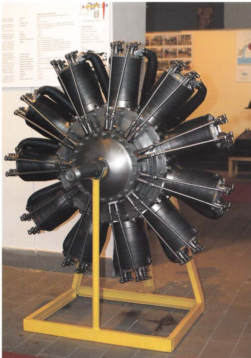
Sopra, a sinistra, il rarissimo motore a stella birotativo Siemens Halske IIIa; a destra, eliche in legno conservate nel museo e appartenute a velivoli della prima guerra mondiale. A fianco, alcuni dei numerosissimi strumenti aeronautici esposti nel museo palermitano e risalenti sempre alla Grande Guerra.
