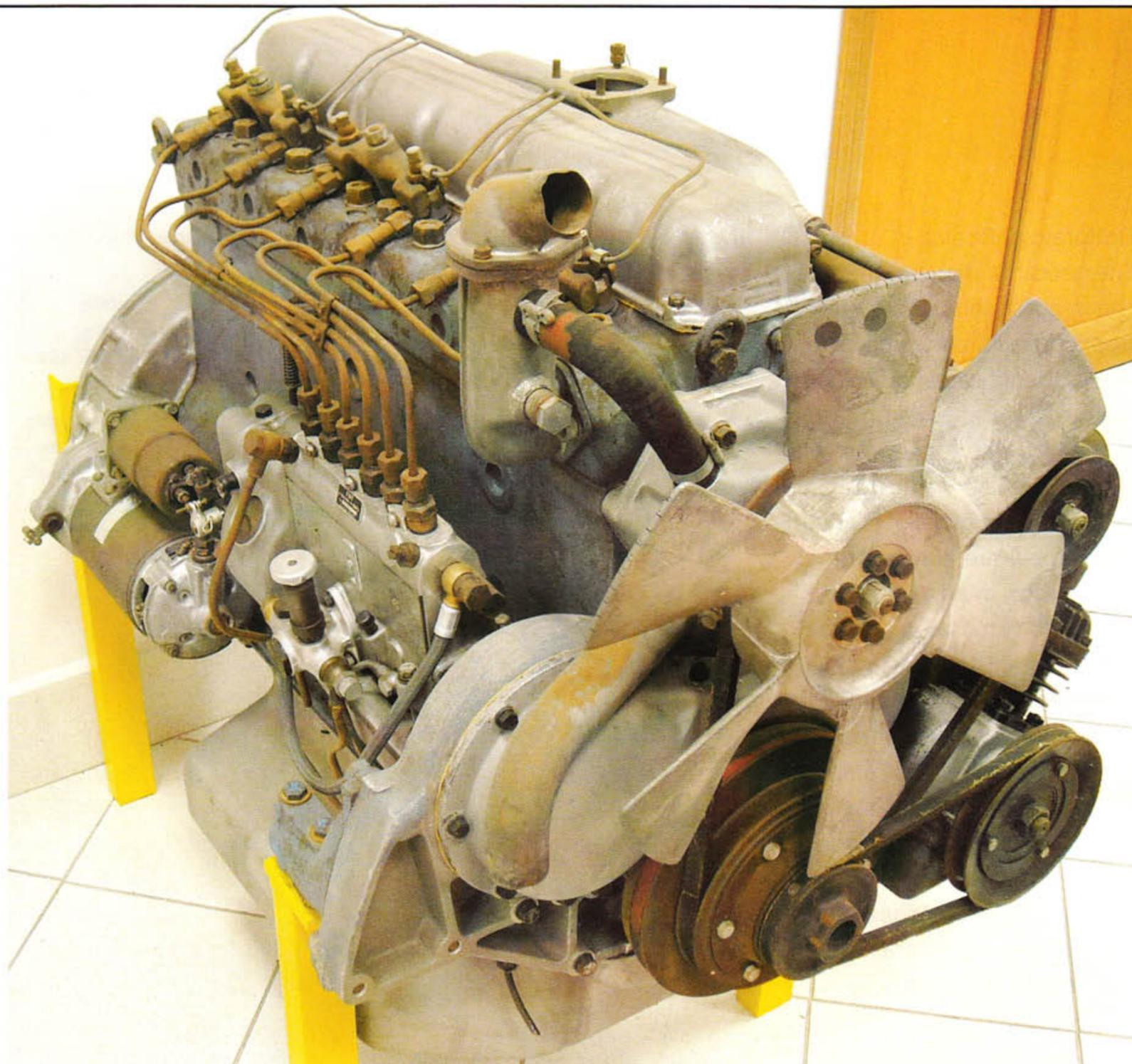
*Il Museo di Palermo rappresenta anche il settore veicoli industriali: questo 6 cilindri in linea da 100 CV è il Fiat tipo 213, montato sull'autocarro 645N del 1959*
