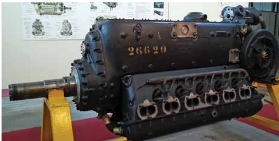
Sotto: il motore aeronautico Daimler-Benz DB-605 A, 12 cilindri a V di 60° invertita, raffreddato a liquido, sovralimentato con compressore centrifugo a comando meccanico e giunto idraulico, sistema di iniezione diretta Bosch, potenza max. 1.475 CV a 2.800 giri/minuto; 1941-1945.
