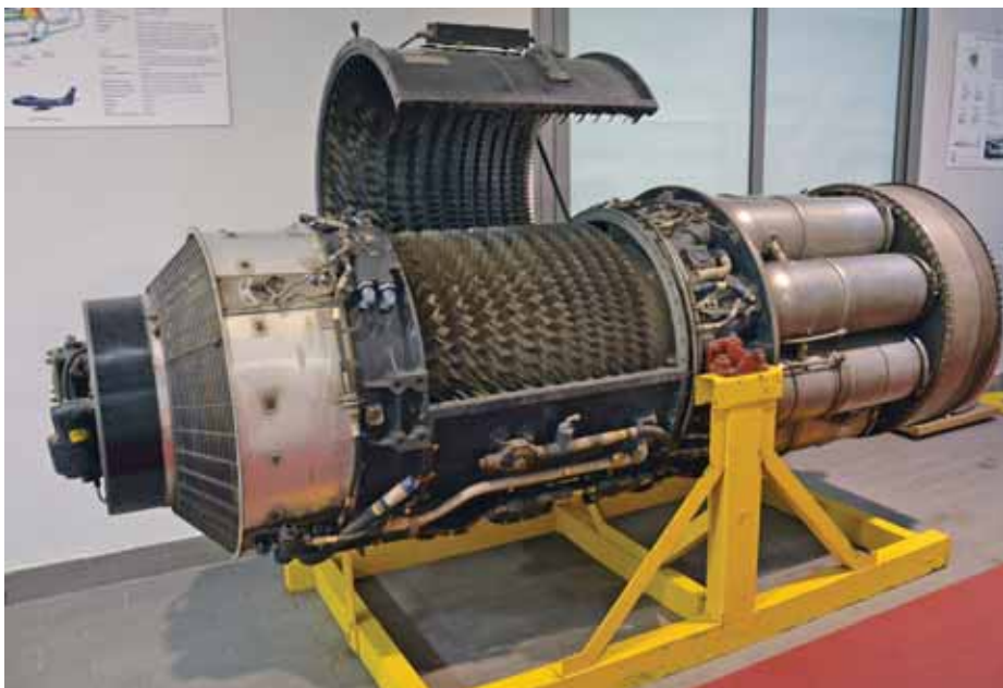
Motore aeronautico turbogetto General Electric J47-GE-13. 1948-1956. Il J47, uno dei primi turboreattori a flusso assiale, fu realizzato complessivamente in più di 36.000 esemplari e venne impiegato sul caccia F-86 SABRE, sui bombardieri B-47 STRATOJET e B-36 PEACEMAKER nonché sull'aerorifornitore KC-97 STRATOTANKER.
