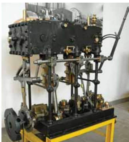
Al centro: il motore a vapore navale, 2 cilindri "compound"; fine '800 inizio '900.
