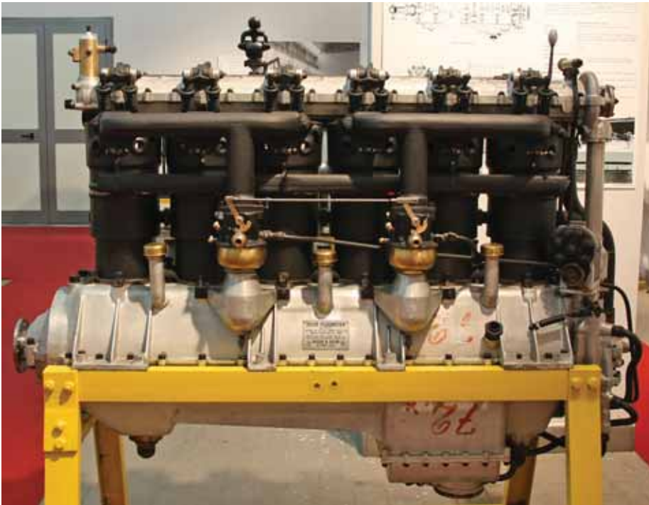
Il motore aeronautico Basse & Selve BuS.IV, 6 cilindri in linea, raffreddato a liquido, potenza massima pari a 300 CV a 1450 giri/minuto. 1917-1918. Sotto: cerimonia di conferimento del riconoscimento internazionale ASME Landmark.
