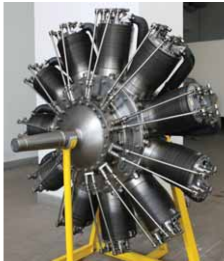
A sinistra: motore motociclistico Frera, monocilindrico 250 cm 3 , con valvole laterali; 1926-1932. A destra: motore aeronautico Siemens-Halske Sh.IIIa, "bi-rotativo" con cilindri radiali, potenza max. 200 CV a 1.000 giri/min; 1917-1918. Sotto: il motore aeronautico Daimler Mercedes D.IV, 8 cilindri in linea, raffreddato a liquido, potenza max. 232 CV a 1.440 giri/minuto; 1915-1916.
