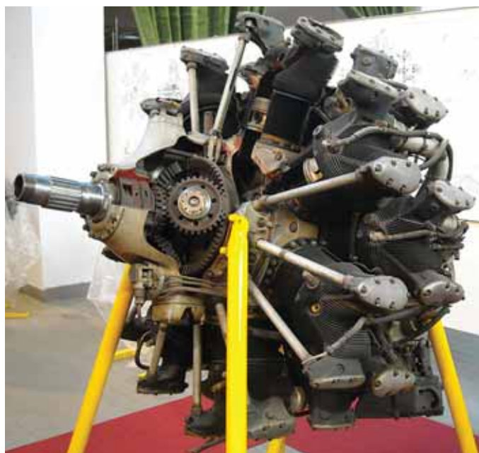
A sinistra: il motore a vapore Neville, monocilindrico per impianto stazionario. Seconda metà del XIX secolo. A destra: il motore aeronautico FIAT A.74 R.C.39, 14 cilindri a stella, potenza max. 840 CV a 2.400 giri/minuto; Seconda Guerra Mondiale.
