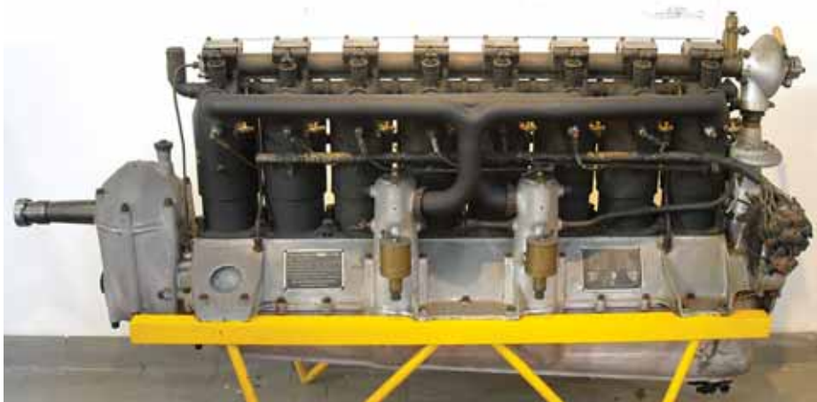
A sinistra: motore motociclistico Frera, monocilindrico 250 cm 3 , con valvole laterali; 1926-1932. A destra: motore aeronautico Siemens-Halske Sh.IIIa, "bi-rotativo" con cilindri radiali, potenza max. 200 CV a 1.000 giri/min; 1917-1918. Sotto: il motore aeronautico Daimler Mercedes D.IV, 8 cilindri in linea, raffreddato a liquido, potenza max. 232 CV a 1.440 giri/minuto; 1915-1916.
