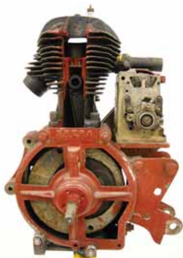
A sinistra: motore motociclistico Frera, monocilindrico 250 cm 3 , con valvole laterali; 1926-1932. A destra: motore aeronautico Siemens-Halske Sh.IIIa, "bi-rotativo" con cilindri radiali, potenza max. 200 CV a 1.000 giri/min; 1917-1918. Sotto: il motore aeronautico Daimler Mercedes D.IV, 8 cilindri in linea, raffreddato a liquido, potenza max. 232 CV a 1.440 giri/minuto; 1915-1916.
