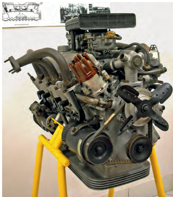
Motore Fiat tipo 104 per vettura Fiat 8V, 1952-1954
